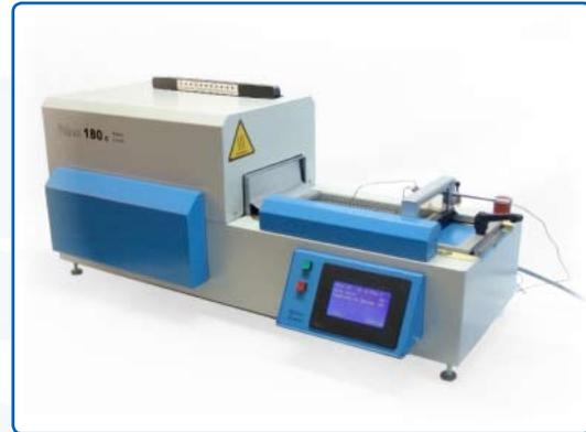
**Fokus 200 pu Heisluf-Umluftmaschine mit IR-Unterstützung. Vollgeregelt PC-gesteuert. Für höchste Ansprüche auf kleinstem Raum.**
